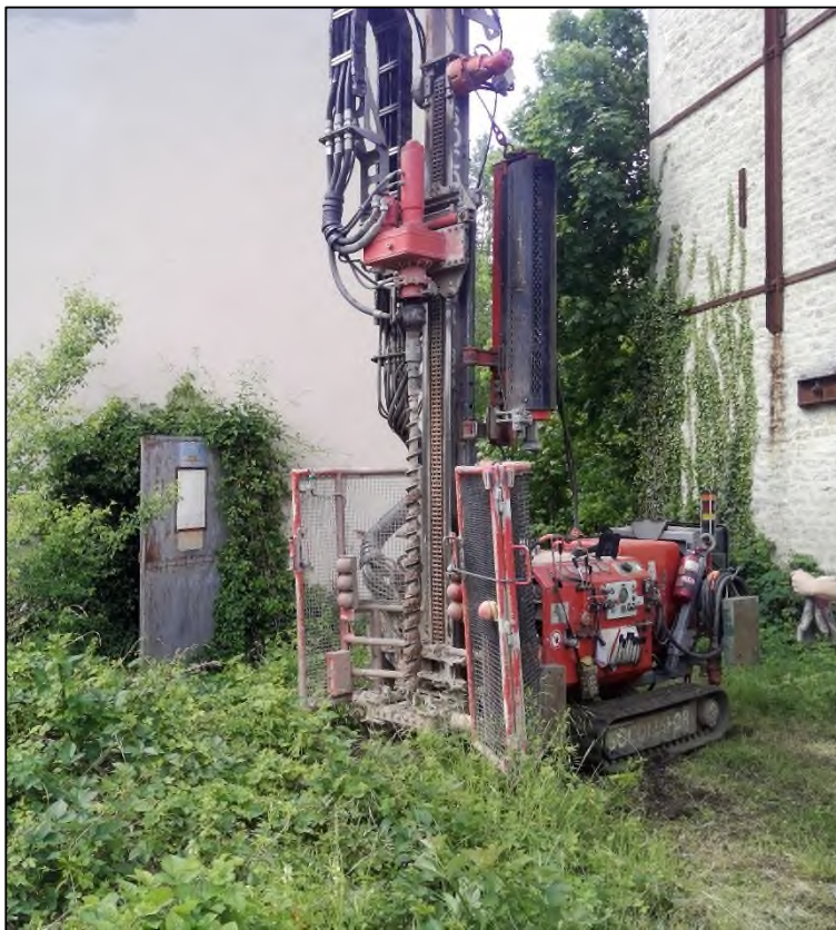
Figure 8.1 : Photographie de l'atelier de forage (Source : TAUW France)
